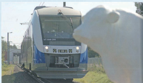
試験線における障害物検知の試験 《出典 SIGNAL+DRAHT》
