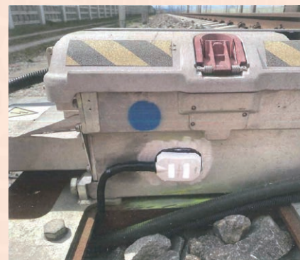
転てつ機に取り付けられた vaSIG の内蔵測定センサー「zentrak IM」 《出典 Eisenbahntechnische Rundschau》
