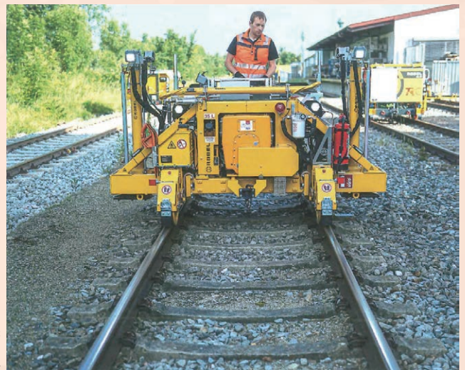
HGR (油圧式レール昇降整正機) の全体イメージ 《出典 Der Eisenbahningenieur》
