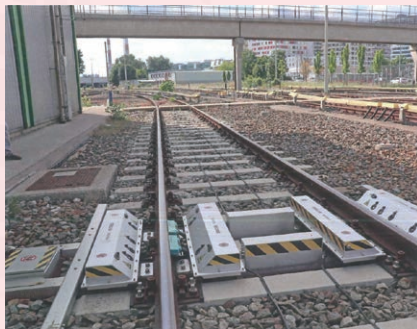
ウィーン交通局鉄道路線の Wien Erdburg に設置された CALIPRI X 測定装置 《出典 Eisenbahntechnische Rundschau》
