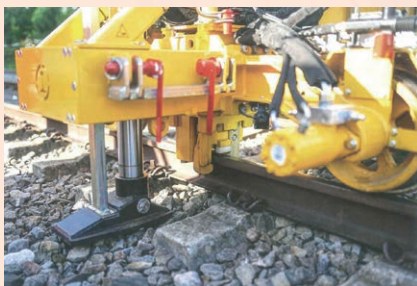
グリップブライヤー (レール掴み具) 《出典 Der Eisenbahningenieur》
