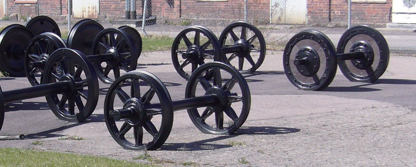
図3 種々のタイヤ車輪（右奥は木製輪心の「マンセル車輪」）
