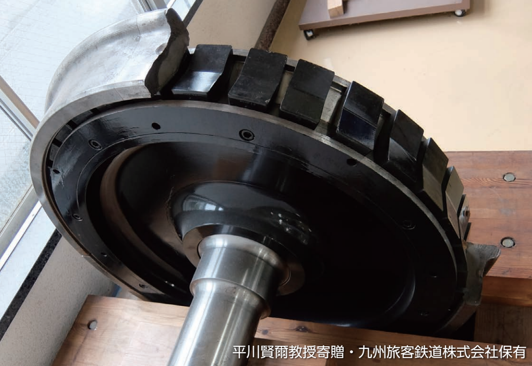
図4 ICE-1車両の弾性車輪の構造を示すカットモデル
