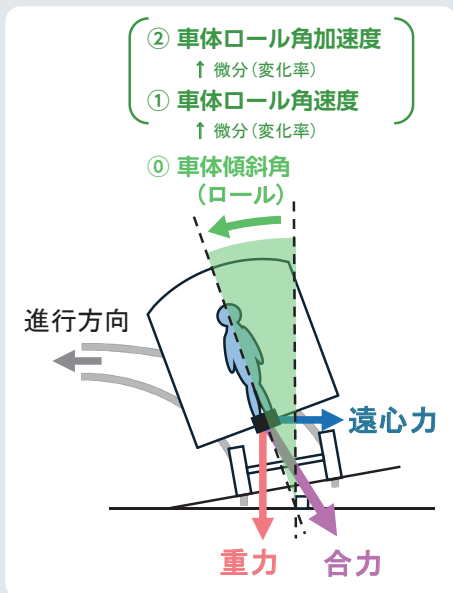
図3 曲線通過時の車体傾斜と車体ロール角速度・角加速度の目安値
