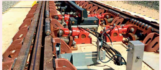
軌間変換装置は中央のバーを使用して輪軸のロックを解除し、油圧アームを使用して軌間が変化するとき車輪をスムーズに動かす 《出典 Railway Gazette International》
