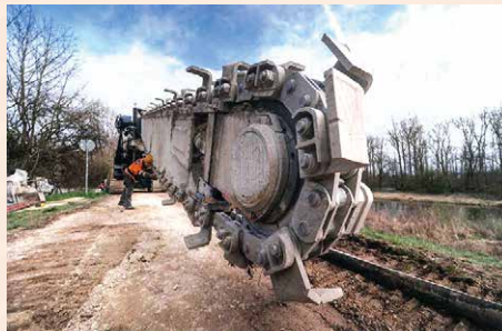
特別に開発された突出ブレードを有するロータリー式掘削機（回転チェーンは路盤を緩めると同時に水と凝固剤の混合液を注入可能） 《出典 Eisenbahntechnische Rundschau》
