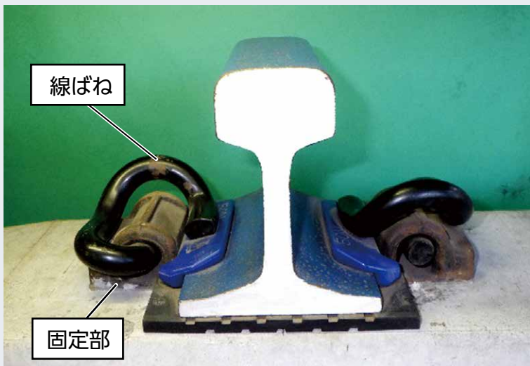
図6 パンドロール社製の締結装置（無螺締式）
