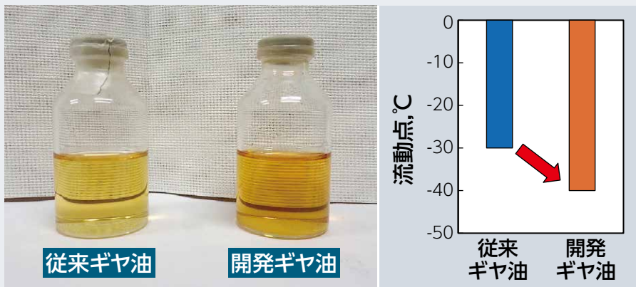
図4 寒冷地走行に対応したギヤ油の開発
