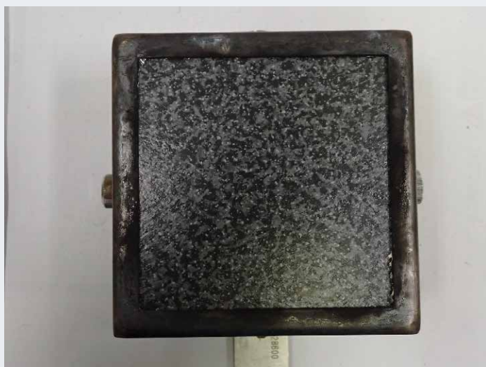
図6 CCM-IR試験装置前後の試験体の状態
