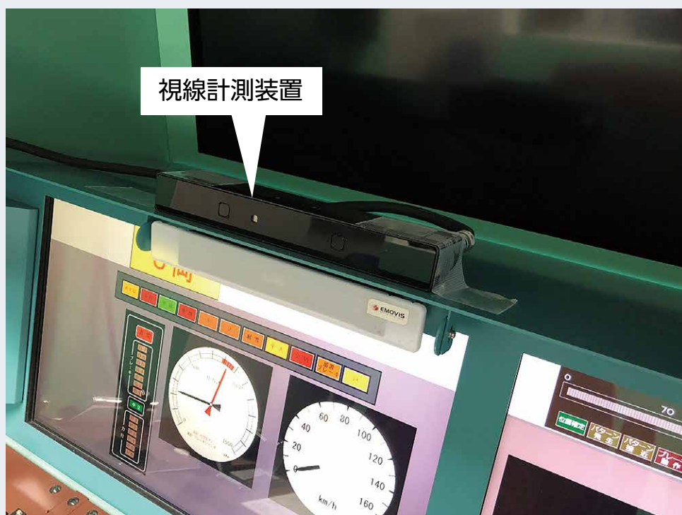
図1 運転シミュレーターに設置された視線計測装置
