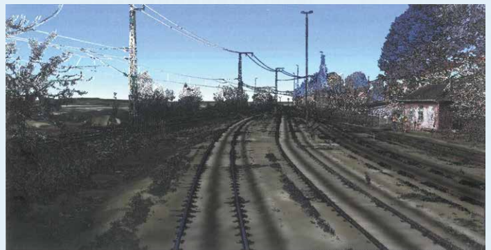
列車からの撮影画像を用いて構築された点群
