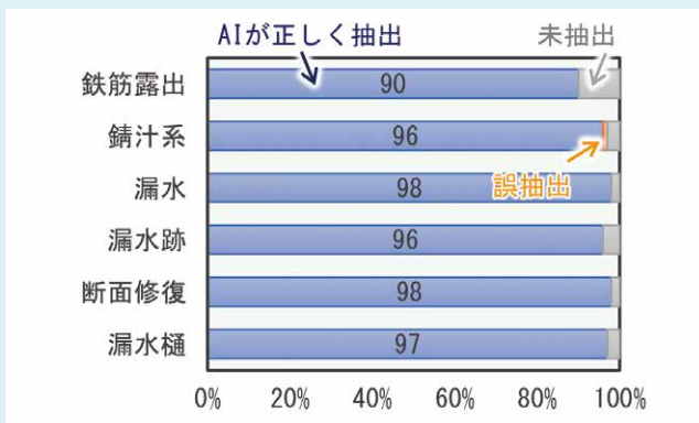
図2 変状抽出AIの精度検証結果の例
