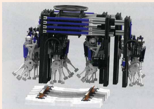
個別に操作可能な 32 個のタンピングツールを有する万能つき固めユニット
