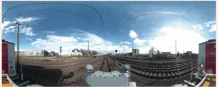
MSS 検測における 360°カメラセンサーの録画の表示 (出典: DB エンジニアリング & コンサルティング社) 《出典 Der Eisenbahningenieur》
