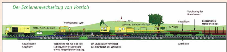
レール輸送システム (STS/OW)、レール積み下ろし貨車 (AAW) および K ワゴンによるレール交換手順 《出典 Der Eisenbahningenieur》
