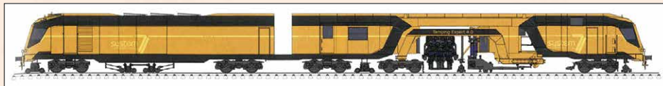
スタビライザユニット KSA 付き 2まくらぎ連続タンピングロボット CPLS32
