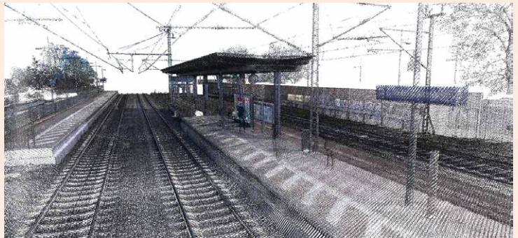
MSS 検測による地理参照点群内の駅の表示 (出典: DB エンジニアリング & コンサルティング社) 《出典 Der Eisenbahningenieur》
