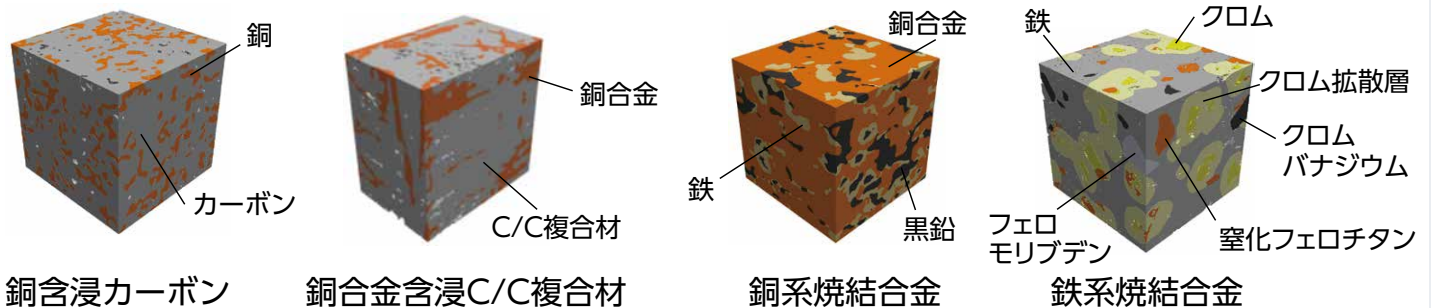
図14 各種すり板とすり板材の微視的構造モデルの例
