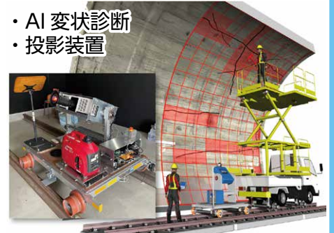
トンネル詳細検査
