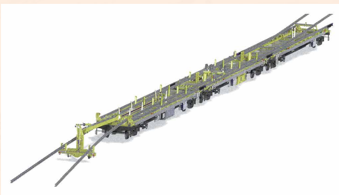
3両の長物貨車で構成されるユニットは全自動化され、遠隔で操作される。 《出典 Der Eisenbahningenieur》
