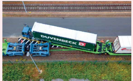
Helrom 社の回転プラットフォーム車体のコンセプト 《出典 Railway Gazette International》
