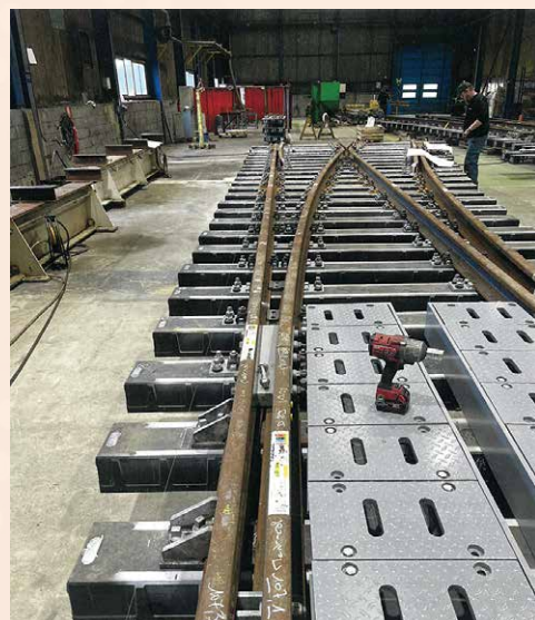
モントリオールのプロジェクト向けに組み立てられた分岐器 《出典 Eisenbahntechnische Rundschau》
