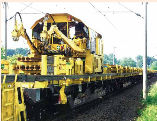
マニピュレーター(制御操作部)と搬送ユニットを備えたモジュール化されたレール積載システム 《出典 Der Eisenbahningenieur》
