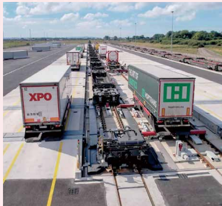
CargoBeamer 社はクレーンを使わないセミトレーラートラックの鉄道への積み降ろし技術を開発した 《出典 Railway Gazette International》
