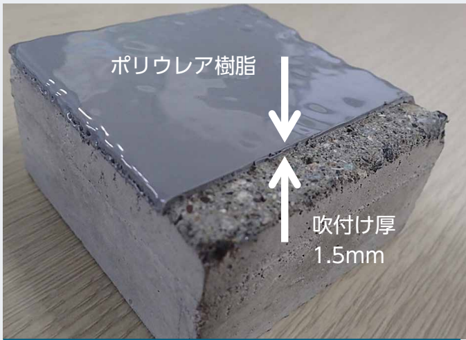
図4 ポリウレタ樹脂を吹き付けた状態(カットモデル)
