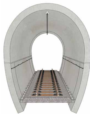
場所打ちコンクリート
