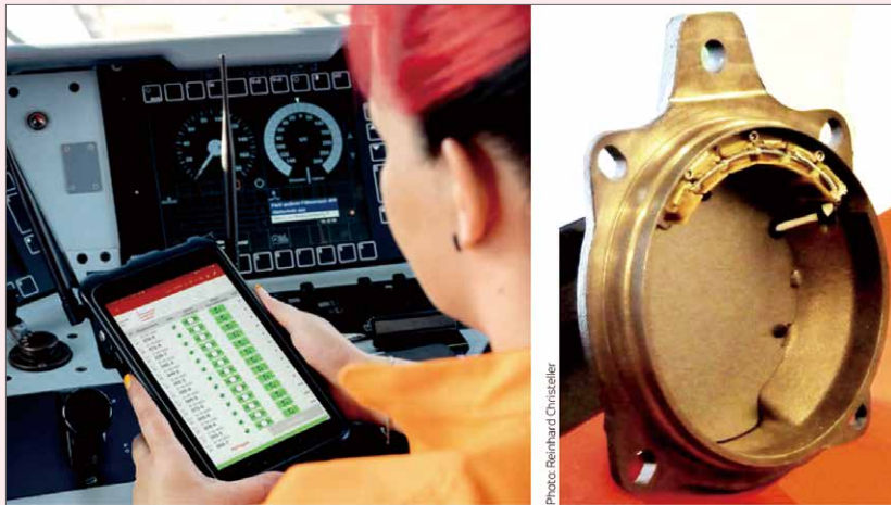
左上：スイス連邦鉄道の子会社 SBB Cargo は貨物列車の自動ブレーキ試験を最初に採用した事業者と自称している。同試験は数分で完了し、機関車の運転士だけの監視でできるため、ターミナルや操車場の作業要員が軽減される。／右上：簡単に後付けできる車軸発電機によりスマート貨車装置に電力が供給される。 《出典 Railway Gazette International》
