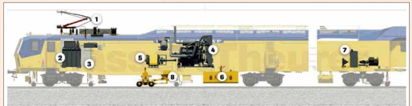
E³ 駆動方式の概略図：1.パンタグラフ 2.トランス 3.インバーター 4.ディーゼルエンジン 5.発電機 6.燃料タンク 7.油圧パワーパック 8.ダイナミック軌道スタビライザー 《出典 Railway Gazette International》
