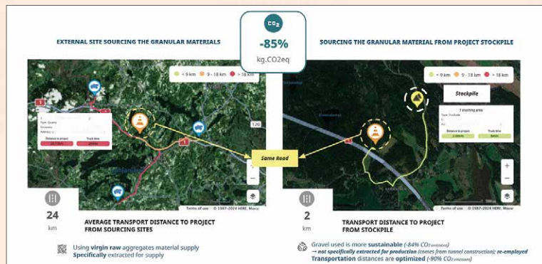
材料調達の違い（左：新材料の24kmに及ぶ輸送、右：備蓄材の取り崩し）によるCO 2 発生量への影響 《出典 Der Eisenbahningenieur》
