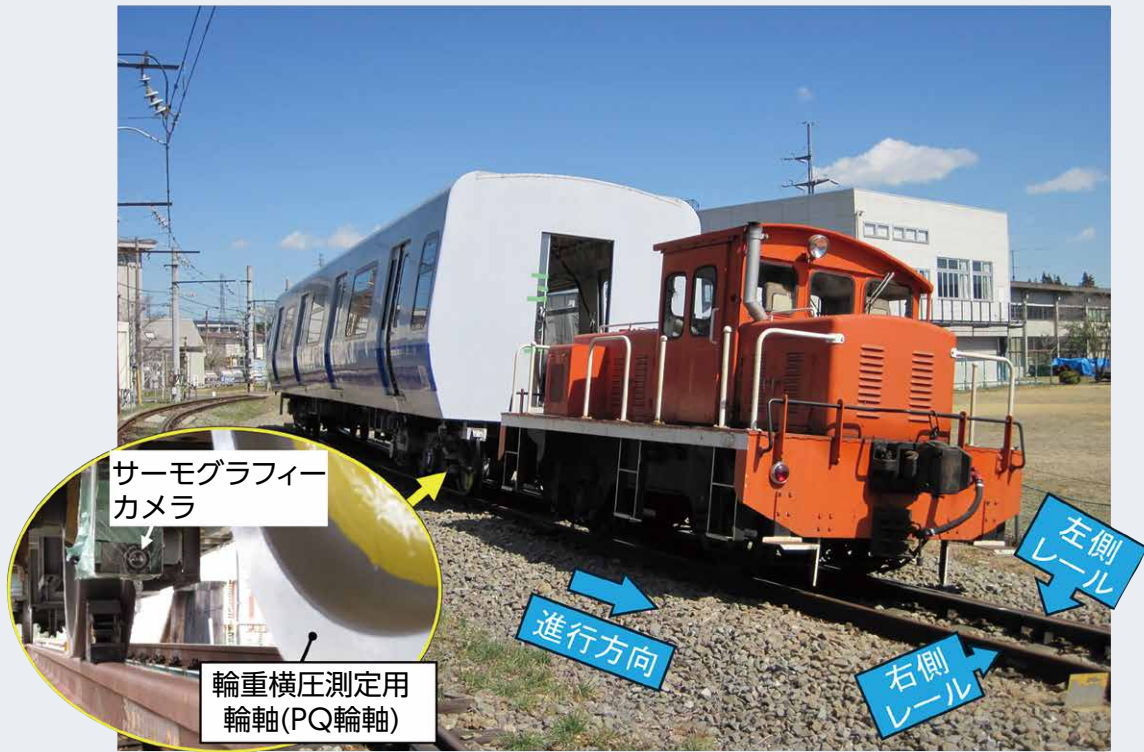
(a) 鉄道総研の構内試験線における走行実験
