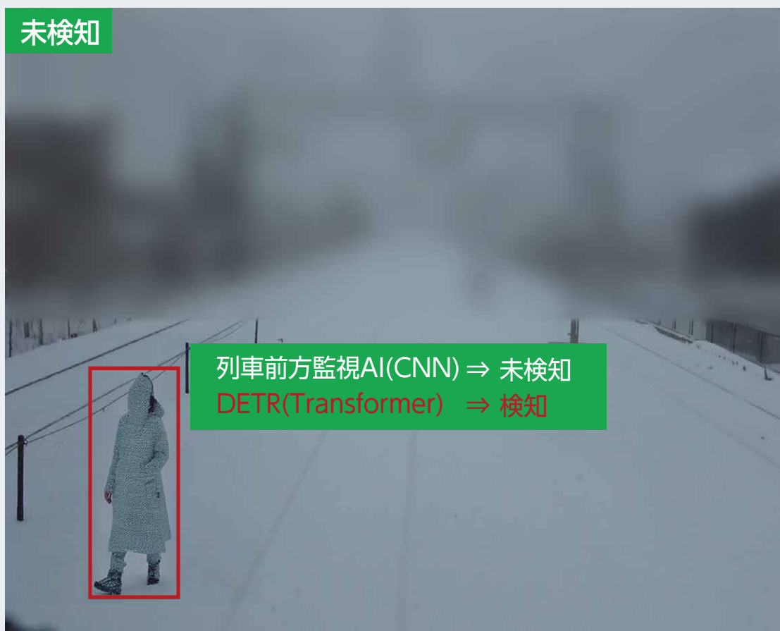
図10 AI構造の検査による判断ミスの推定の例
