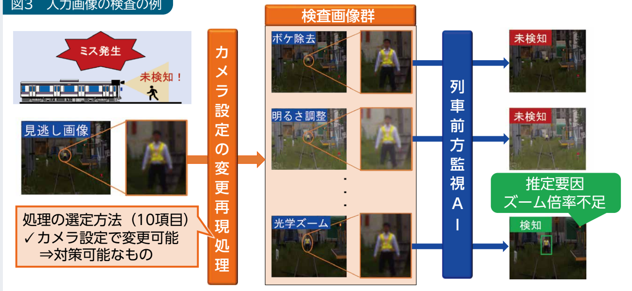
図3 入力画像の検査の例
