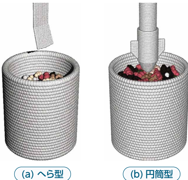
図9 つき固め試験の個別要素法の解析モデル
