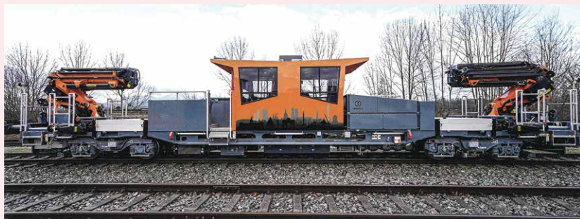
ミュンヘン交通会社の電気式軌道モーターカーは、前後対称構造で双方向運転用に設計されている (出典: Robel Bahnbaumaschinen GmbH) 《出典 Der Eisenbahningenieur》
