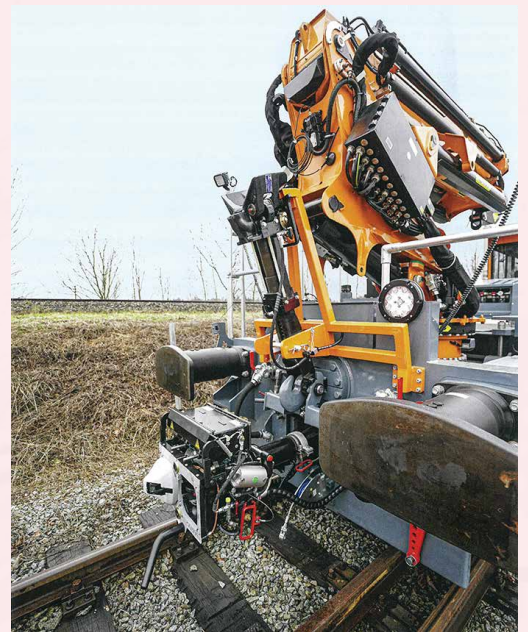
地下鉄および幹線鉄道での運用のために、車両にはサイドバッファ、追加の入替連結器 (Rangierkupplung)、および空気圧で下降可能なシャープフェンベルグ式密着連結器 (SchaKu) を含む標準的な牽引システムが装備されている (出典: Robel Bahnbaumaschinen GmbH) 《出典 Der Eisenbahningenieur》
