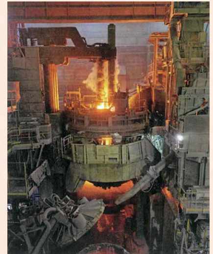
ザールシュタールアスコバルは, 電気アーク炉 (EAF) で鉄スクラップを溶解する(出典: Saarstahl Ascoval / Anton in Laine)
