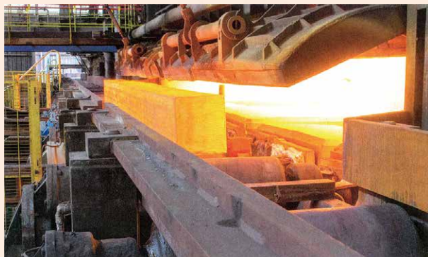
ハヤンゲのザールシュタール鉄道では, 圧延プロセスのためにブルームを炉で再加熱する(出典: Saarstahl Rail Hayange)
