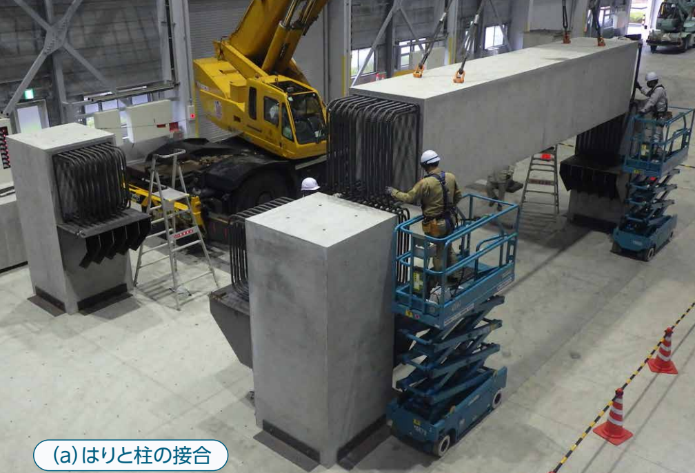
図5 実物大模型による施工試験
