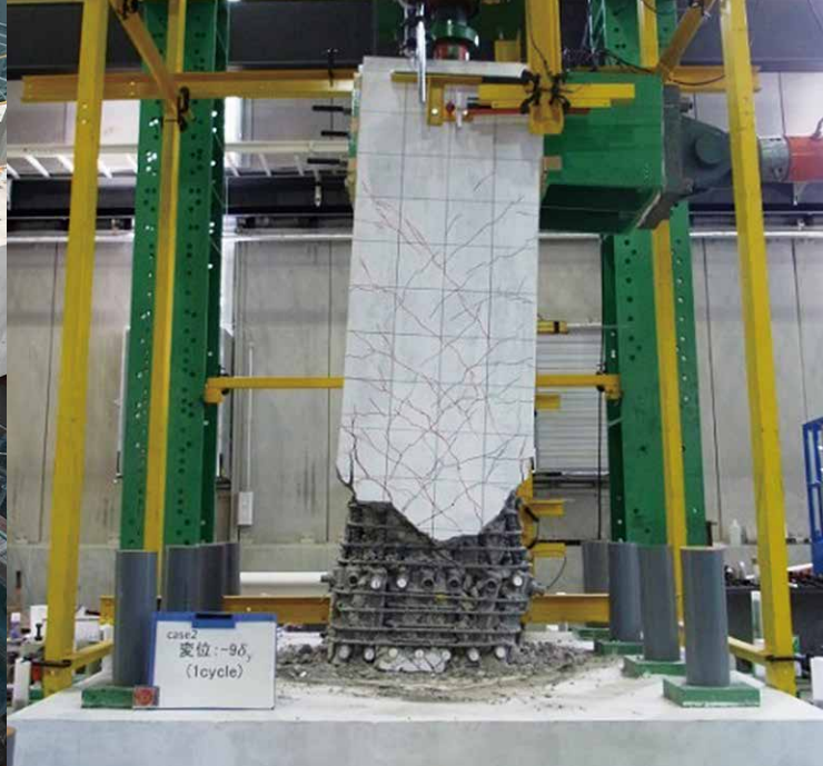
図3 プレキャスト工法での正負交番荷重実験
