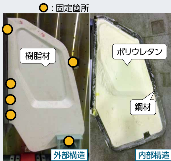
(b) 袖仕切り構造と固定箇所
