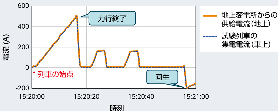
図6 設備健全時における変電所・列車での電流の照合結果
