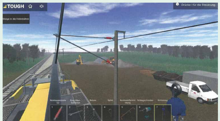
仮想 (VR) 作業台からの視野。必要な工具は準備され、碍子の交換作業は開始可能である。 《出典 Eisenbahntechnische Rundschau》
