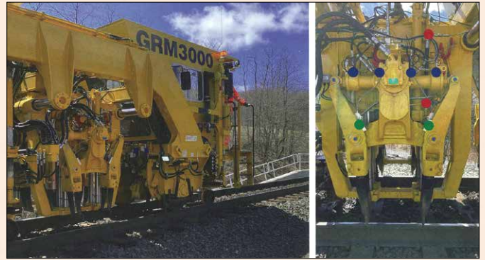
道床タンピングマシン GRM 3000 (左)と、データ収集に使用されるセンサーの正確な位置を示したタンピングユニット (右) - サイドシリンダーの圧力センサー (青)、昇降シリンダーの圧力センサー (赤)、角度センサー (緑) (出典: B.Antony)
