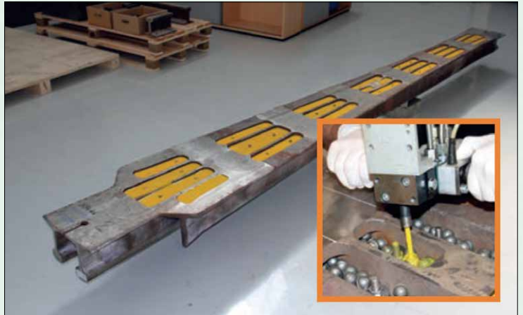
ブフシュテッテンでの現地試験で使用された防音分岐器のクロッシング用の複合材料 《出典 Railway Gazette International》
