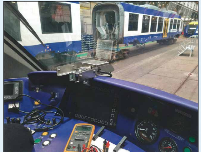
《出典 SIGNAL+DRAHT》 LINT41 型車両の運転台へのカメラの設置 (出典: Alstom) 《出典 SIGNAL+DRAHT》
