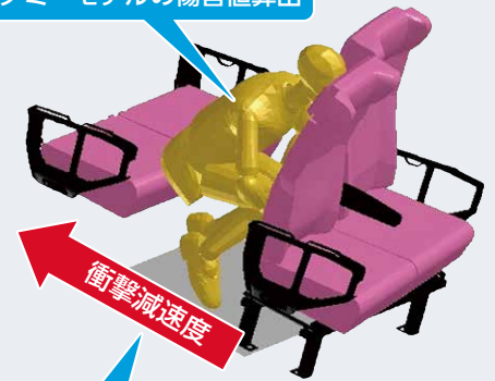
踏切事故衝突解析で 算出した減速度波形を入力
