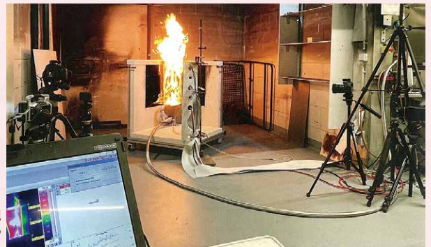
BESKID プロジェクトの一環としてのPMMA (アクリル樹脂) の中規模検証テスト (出典 : M. Osburg)
