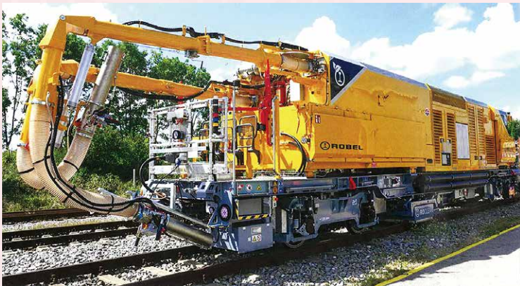
自動吸引ユニットと吸引ホースによる手動清掃を組み合わせた半自動清掃装置 《出典 Der Eisenbahningenieur》
