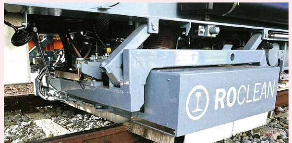
走行中、吸引バーのノズルが進行方向に移動して表面全体をカバーし、吸引システムの空気流により汚れを吸引する。 《出典 Der Eisenbahningenieur》
