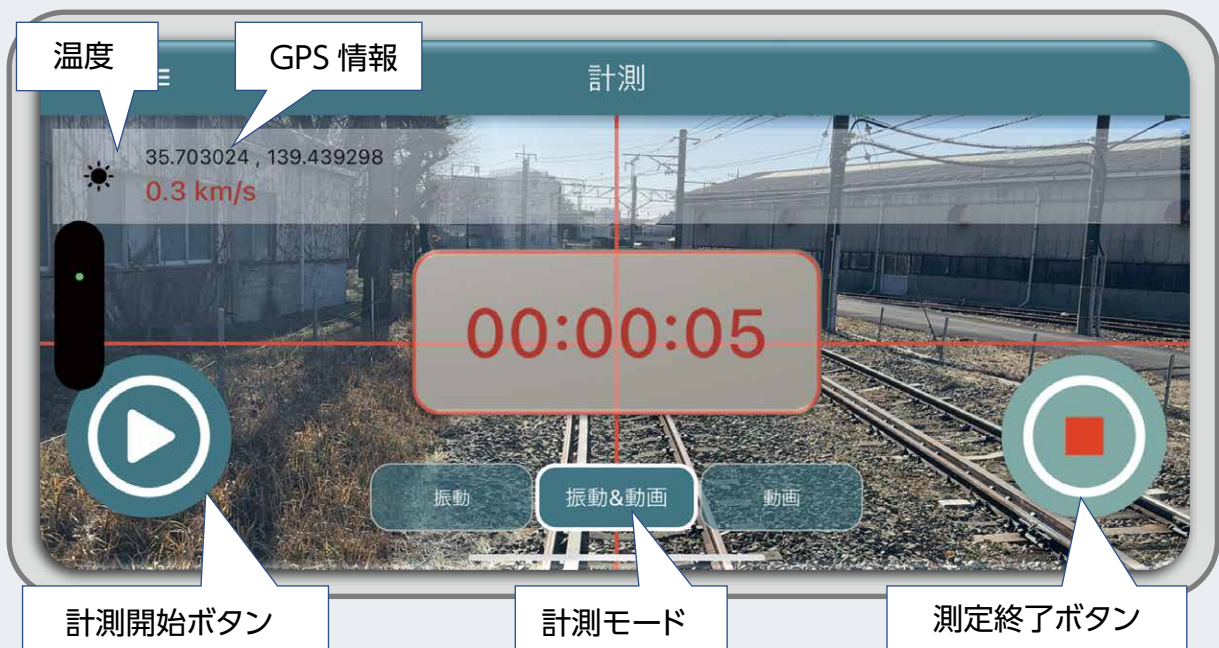
図7 車上で列車動揺の波形を簡易に計測するために開発したアプリケーション
