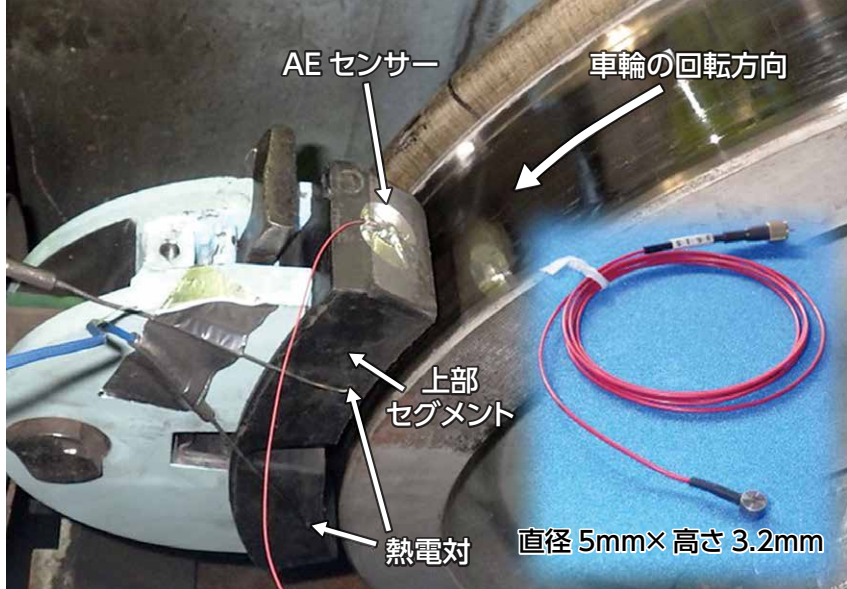
図2 実物大台上ブレーキ試験
