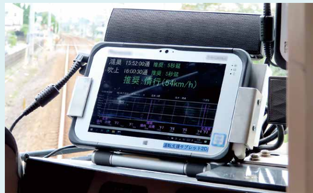
図1 運転支援システムの運転台への設置事例
