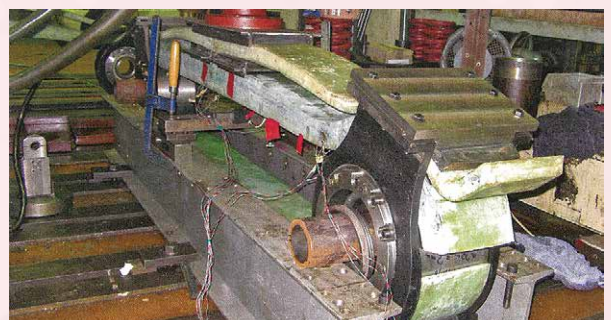
台車枠の周期的繰り返し荷重の実験装置
