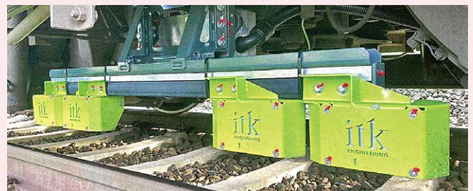
試験走行中の鉄道車両に搭載された車載磁気センサー (MAROS) 出典: ITK Engineering 社
