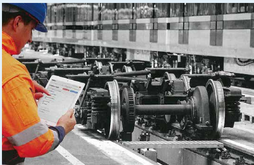
鉄道車両工場の従業員は zedas®asset Touch を使用して車両部材の交換を記録する
