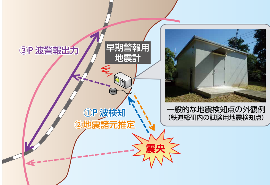
図2 早期警報用地震計によるP波警報出力の流れ
