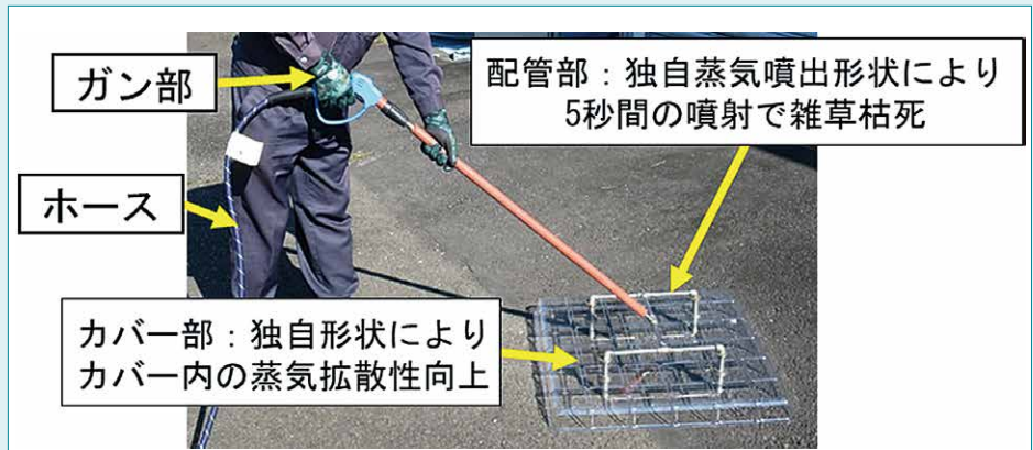
図2 新たに開発した手持ちノズルの構成
