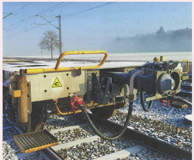
パイロット列車には DAC (デジタル自動連結器) と追加の電源およびデータ接続機能が装備されている 出典: SBB/CFF/FFS
