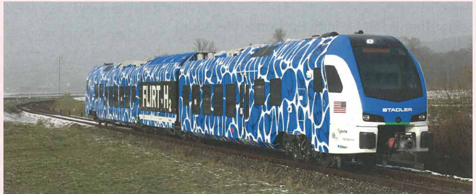
燃料電池で試験走行中の FLIRT H 2 出典:トビアス・シュテュルツ
