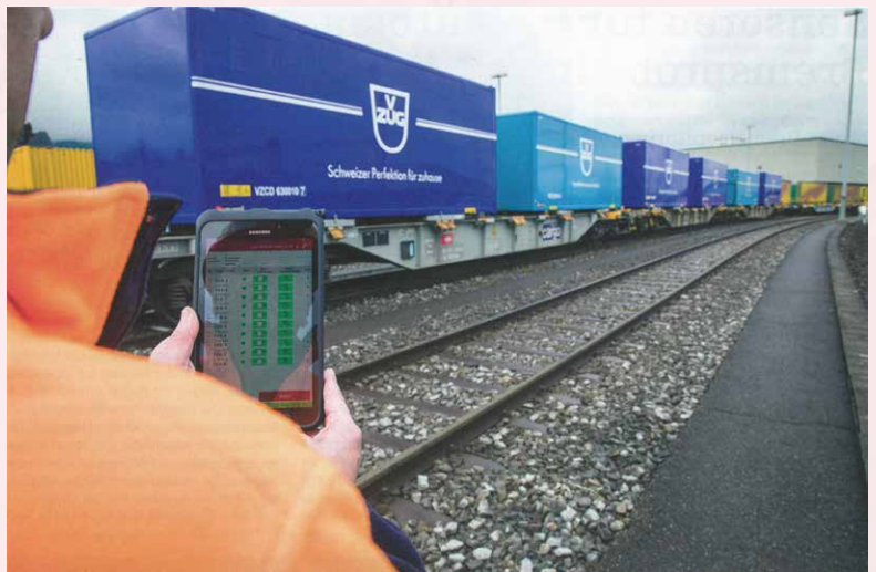
ABP (自動ブレーキ試験) の一部として行うブレーキ測定の評価は、列車運転士またはブレーキ試験に権限のある人のタブレット上に明確に表示される。
