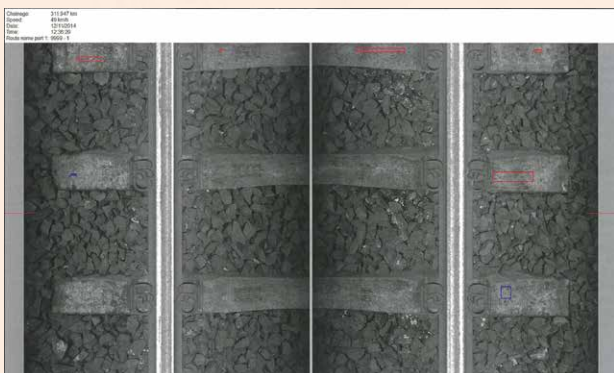
CrackCheck ツールを用いた道床部の検測外観
