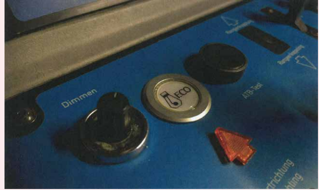
機関車停止かそれとも運転継続か？運転席の押しボタンが点滅することで通知され、運転士は運転を継続するためボタンを押してアイドリングストップスタート機能を手動で解除するか、あるいはボタンを押さずに自動的に機関車を停止させるか、選択することができる。
