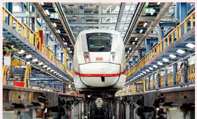
ベルリン・ルンメルスブルクの新しい検修庫で床下、屋根上などすべての方向から検査されるICE4。(原典: Photo: DB AG / Volker Emersleben)
