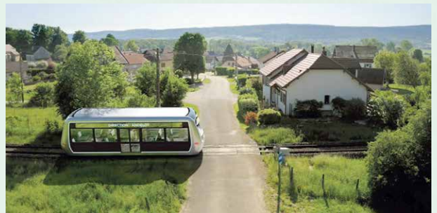
Drais 車両が踏切上にある場合 (Drais システムの車両は踏切付近では低速走行し、踏切上に横断車両がある場合は運転士が (将来的には自動制御で) 停止させる)。(原典 (Image): SNCF)
