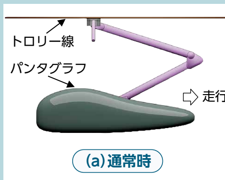
図3 架線着霜により離線が発生する様子
