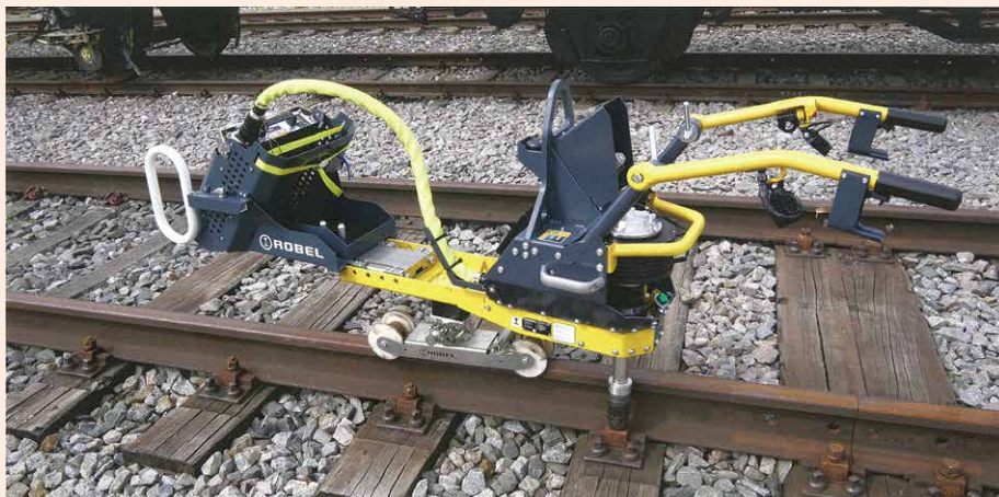
全電気式精密ボルト締め機械 30.76E 3 (原典 : Robel Bahnbaummaschinen GmbH)
