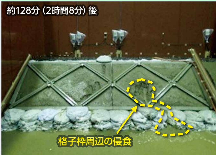
図6 盛土崩壊実験結果（崩壊の形状）
