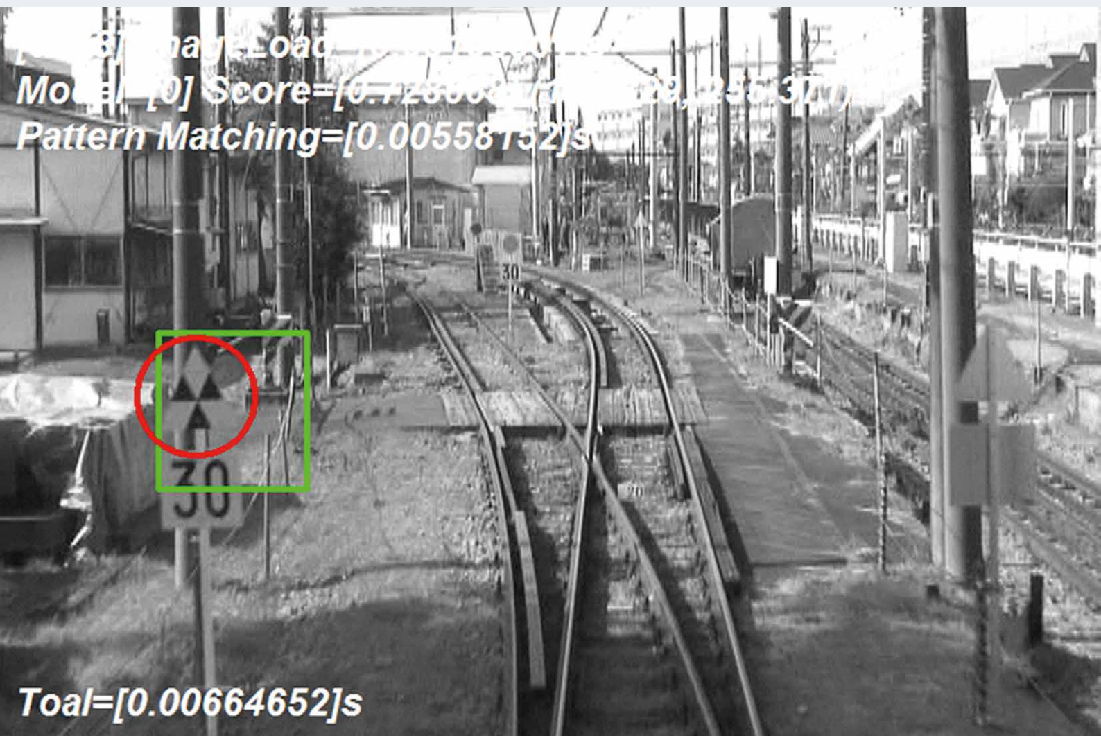
図3 徐行予告信号機を検知している様子
