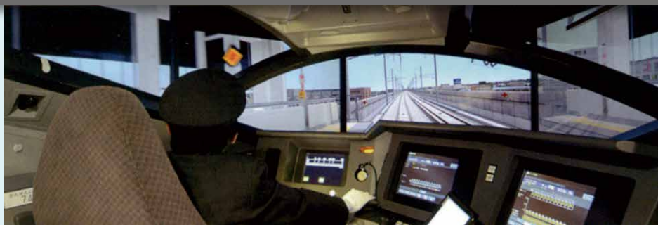
図1 運転シミュレータの例（実車を完全に再現した運転室）
