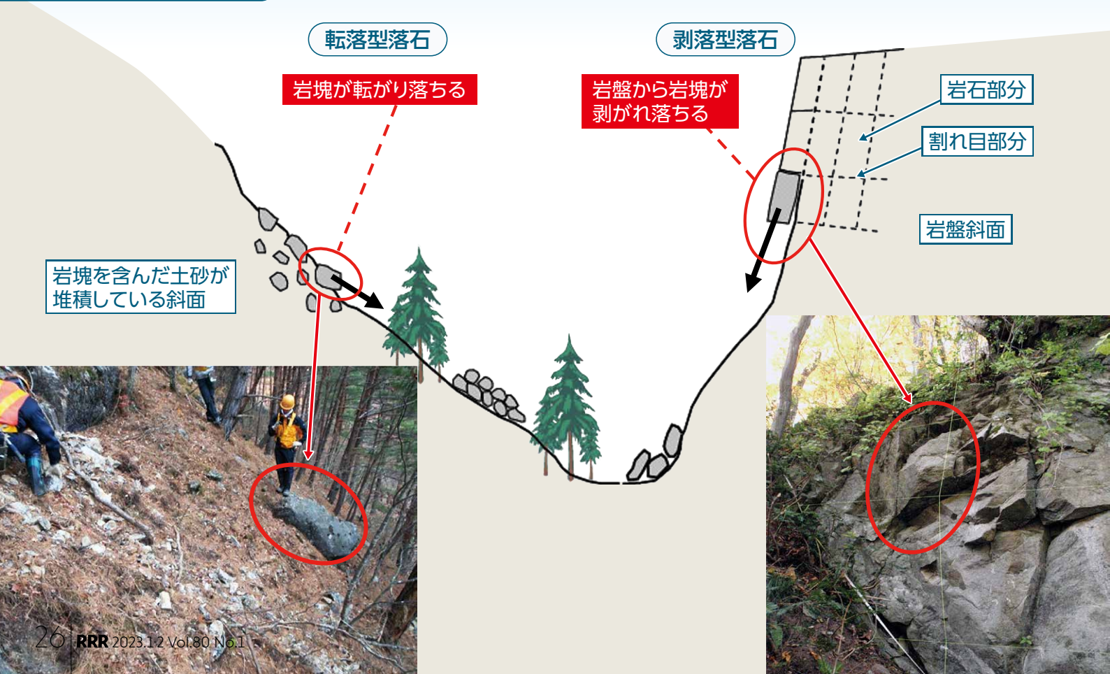
図1 落石発生のタイプ
