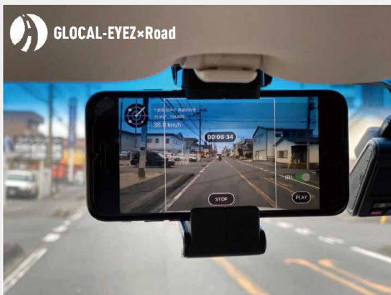
図1 スマートフォンを活用した簡易な路面モニタリングシステム (DRIMS/GLOCAL-EYEZ)
