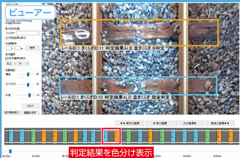
図2 列車前方画像を用いた木まくらぎ劣化度判定システム
