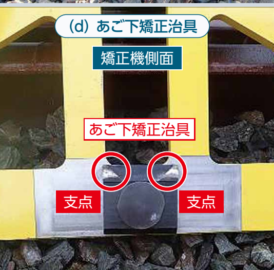
図7 新型矯正機の概要と矯正状況
