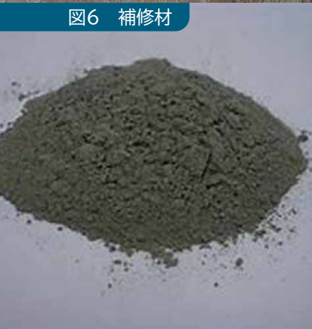
(a) 超速硬セメント
