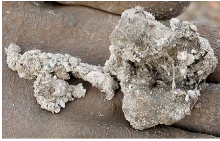
バラストの低強度安定処理 14)
