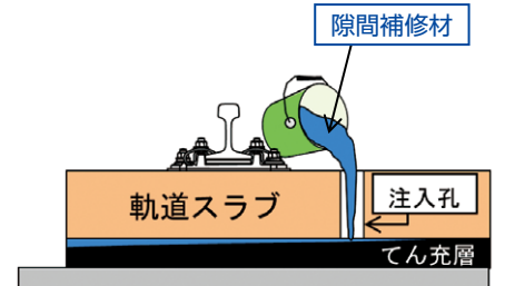
軌道スラブ下の隙間補修 18)
