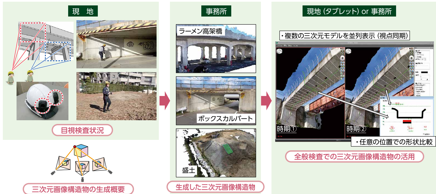
図2 三次元画像による構造物の目視検査支援システムと活用
